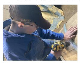
Fasses. Damit es später auch gut aussieht, habe ich die Löcher im möglichst gleichen Abstand gebohrt. Nun platzierte ich im jedem Loch von aussen eine Sechskantschraube und befestigte diese mit Unterlagscheiben und Muttern im inneren des Fasses. Als die Ringe montiert waren, habe ich sie mit einem speziellen Aufsatz für die Bohrmaschine geschliffen. Dies war eine anstrengende Arbeit, aber der Aufwand hat sich gelohnt. Danach sahen sie fast aus wie neu.
